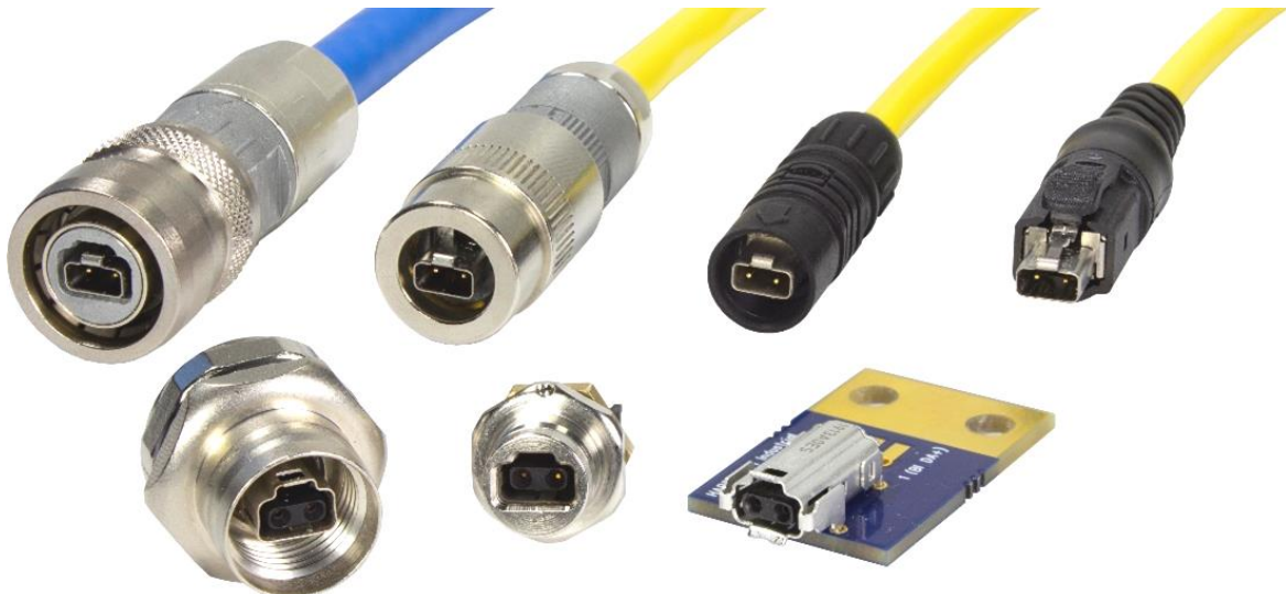
Bild 6: T1 Industrial SPE Steckverbinder-Ausführungen nach IEC 63171-6 als IP65/67 sowie als IP20 Ausführungen (obere Reihe v.l.n.r.: M12 PushPull Stvb., M8 PushPull Stvb., M8 SnapIn Stvb. und IP20 Stvb. / untere Reihe v.l.n.r.: M12 Buchse mit Schraub- und PushPull-Verriegelung, M8 Buchse mit SnapIn- und PushPull-Verriegelung, gewinkelte IP20 Leiterplattenbuchse) (Quelle: HARTING)
