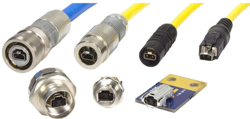
Bild 4: SPE Steckverbinder-Ausführungen nach IEC 63171-6 als IP65/67 sowie als IP20 Ausführungen (obere Reihe v.l.n.r.: M12 PushPull Stvb., M8 PushPull Stvb., M8 SnapIn Stvb. und IP20 Stvb. / untere Reihe v.l.n.r.: M12 Buchse mit Schraub- und PushPull-Verriegelung, M8 Buchse mit SnapIn- und PushPull-Verriegelung, gewinkelte IP20 Leiterplattenbuchse) (Quelle: HARTING)
