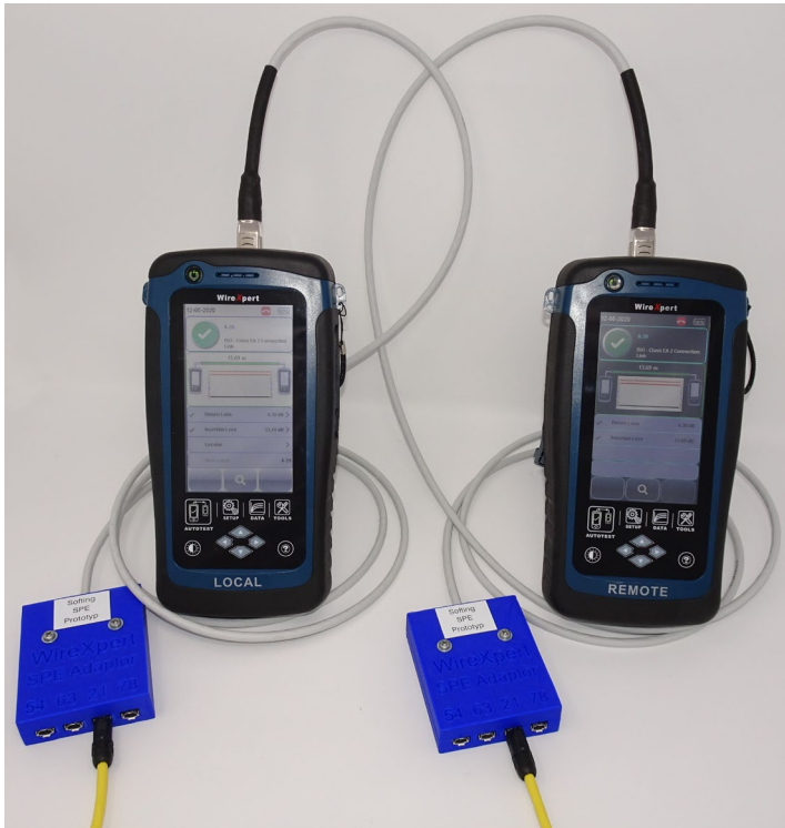
Abbildung 2 WireXpert 4500 mit SPE-Prototyp-Adaptoren
