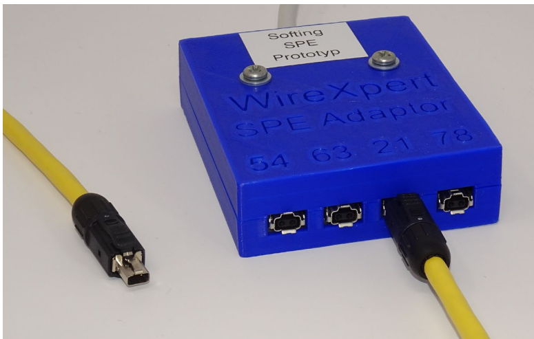
Abbildung 3 4-Port-SP-Prototyp-Adapter für IEC 63171-6-Konnektivität
